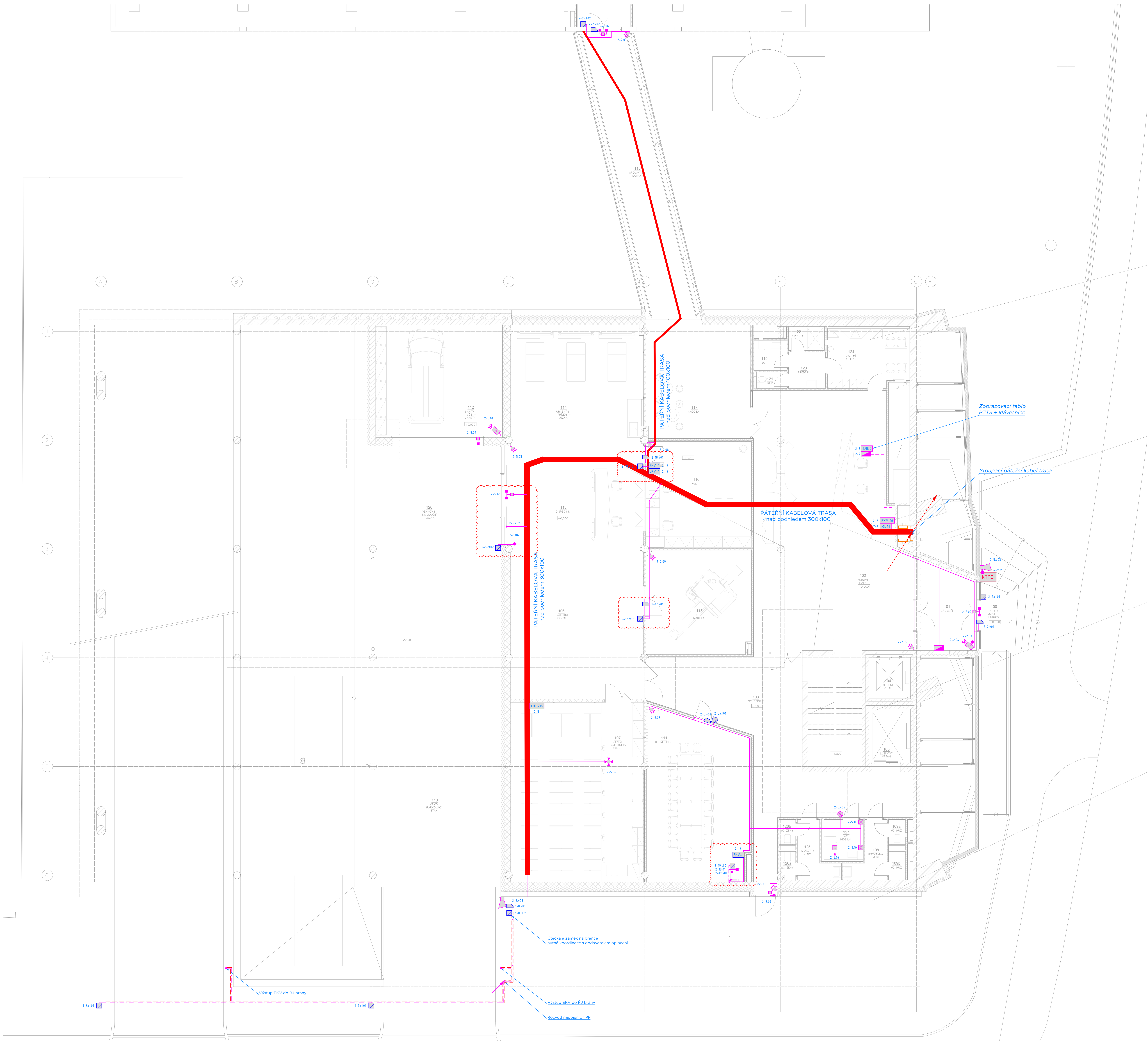
SCHEMA VEDENÍ SLP VE STOUPAČÍ ŠACHTĚ:
